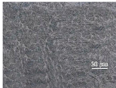
(d) 焊缝显微组织
